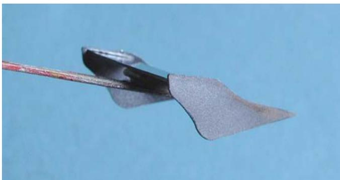
nach Trocknung der Verklebung kann der Heckflügel lackiert werden
